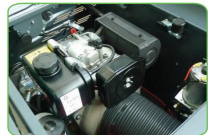
Erhältlich sowohl mit Benzin- als auch mit Dieselmotor, inklusiv Fahrsystem mit variablem Hydraulikantrieb.
