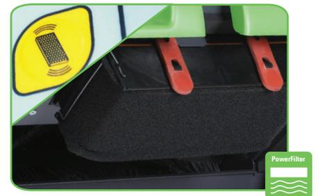
EIN-AUS automatischer Filterrüttler. Der automatische Filterrüttler kann in Zeitabständen von mindestens 1 Minute bis höchstens 8 Minuten programmiert werden. Der Filter wird in Abständen von 2 Sekunden 3 Mal für 5 Sekunden gereinigt.
