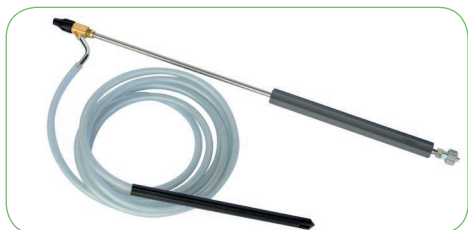
900-mm-Sandstrahllanze mit Punkstrahldüse, Drehverschraubung und Ansaugrohr, geeignet für einen Betriebsdruck von \leq 250 bar Art.-Nr.: 1.258.220.xxxxx
