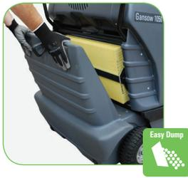
Großer Kehrgutbehälter, im Rotationsverfahren hergestellt, zum Entleeren leicht zu entfernen.
