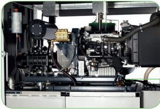
Industrie-Diesellaggregat für den Antrieb der Hochdruckpumpe und des Vakuumsystems
