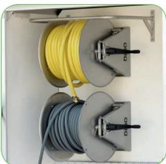
Feste Schlauchtrommeln mit 50 m langem 3/8"-Hochdruckschlauch und 50 m langem 3/4"-Niederdruckschlauch
