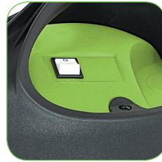
Kunststoffteile aus hochfestem und vollständig recycelbarem Polypropylen
