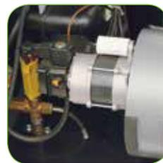
Direkt an Ventilator und Dieselpumpe gekoppelter einphasiger Brennermotor.
