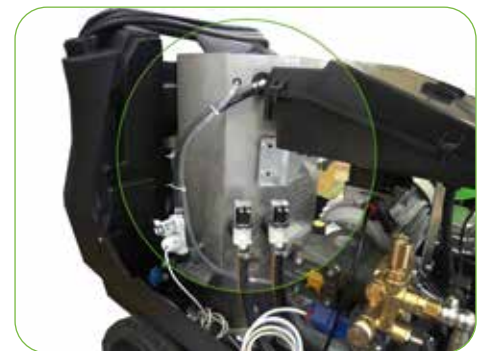
Elektrisch beheizter Brenner
